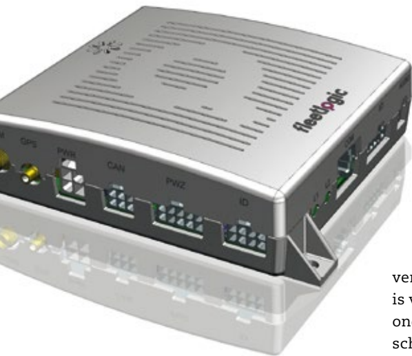
< Ruwe data wordt verzameld in een board-computer, verzonden, bewerkt en inzichtelijk gemaakt voor gebruikers
